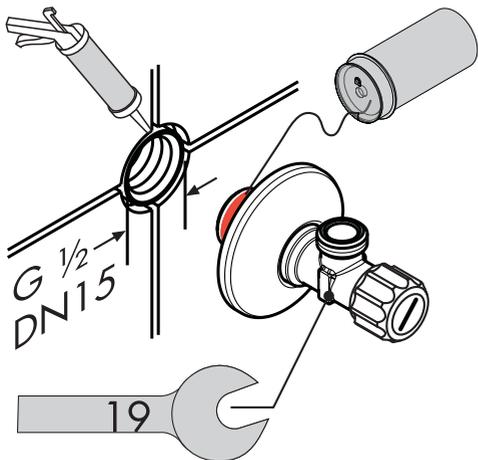
**DE Achtung!** Die beige packten Eckventile müssen montiert werden um Schmutzeinspülungen aus dem Leitungsnetz zu vermeiden. Schmutzeinspülungen können die Funktion beeinträchtigen und / oder zu Beschädigungen an Funktionsteilen der Armatur führen. Hieraus ergebende Schäden unterliegen nicht unserer Gewährleistung!
